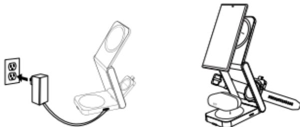
1. Collegare la stazione di ricarica wireless a una fonte di alimentazione utilizzando l'adattatore.
